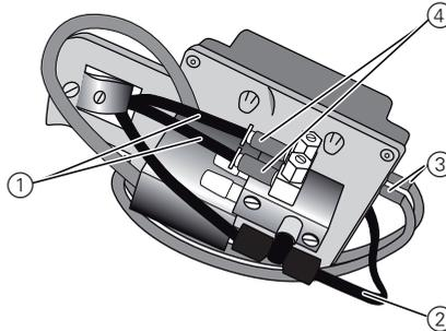
(1) - Tuyaux d'air comprimé pour la tête de machine
