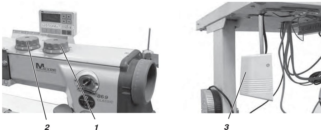
La machine à coudre spéciale 869 est pourvue, selon la sous-classe, en équipement standard de deux roues de paramétrage pour la course du pied compresseur.
