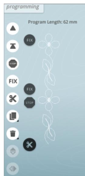
Insérez une commande STOP en appuyant sur le bouton STOP sur l'écran. La commande STOP indique à la machine de s'arrêter à l'endroit sélectionné dans votre point programmé. Ceci est utile, par exemple si vous souhaitez créer un programme de point à plusieurs rangées.
