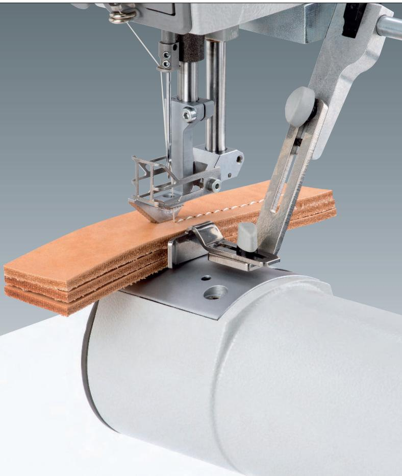
Die besonders robuste Bauweise und der durchzugskräftige Dreifachtransport sorgen für höchste Qualität speziell bei der Verarbeitung extremer Material- und Nähgarnstärken.
