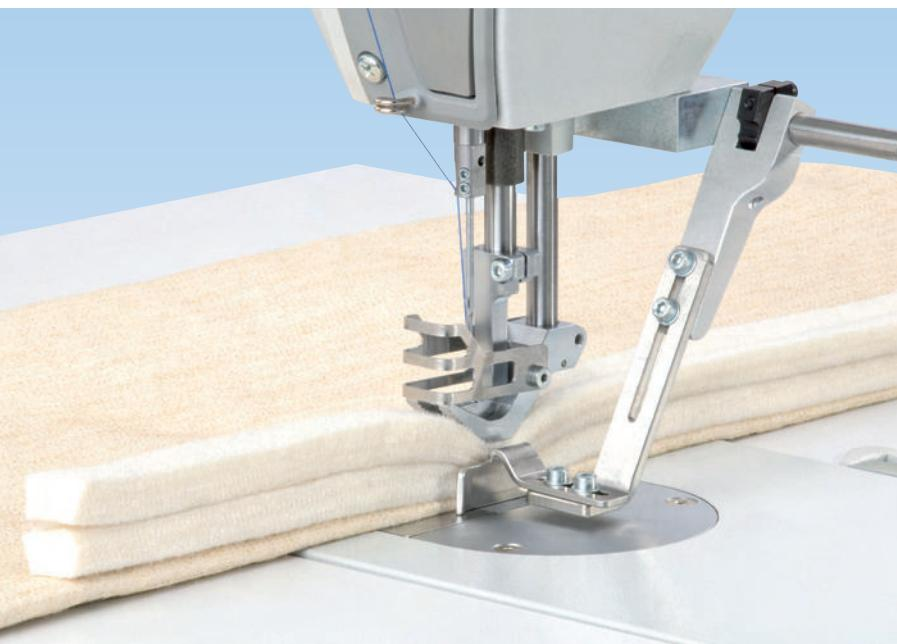
Die große Lüftungshöhe sowie die Verarbeitung extremer Materialgutstärken prädestinieren die H-TYPE für Montagenähte an Technischen Textilien.
