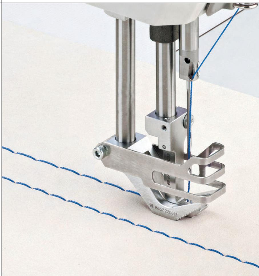
Die Transportkinematik in Kombination mit dem XL-Barellgreifer ermöglicht die Verarbeitung extremer Nähgarnstärken – und das bis zu einer maximalen Stichlänge von 15 mm.
