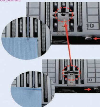
Faites simplement glisser le bouton de devant (flèche) pour commuter vers un trou d'aiguille pour point droit ou quilting. Cousez les tissus les plus légers avec une pénétration d'aiguille parfaite sans déviation. Cela évite un entraînement du tissu à l'intérieur du trou pour un point parfait surtout dans le cas de matières difficiles et un déplacement en free motion précis avec une couture réalisée à la perfection !
