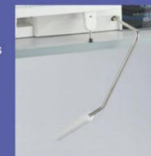
Genouillère électrique permettant de déplacer le pied presseur de haut en bas avec très peu de force et sans retirer les mains du tissu.
