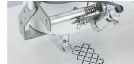
Grâce au pointeur LED, vous pouvez commencer à coudre sans avoir à abaisser l'aiguille pour vérifier la position de départ de la couture. Vous pouvez également fixer une caméra borescope à la place du pointeur LED.
