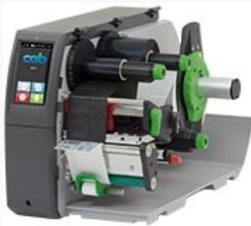
**Modèle P** : sur ce modèle, les étiquettes peuvent être pré-décollées grâce à l'enrouleur interne. Durant l'impression, l'étiquette est retirée de son support. L'étiquette personnalisée est désolidarisée du support par l'arête de pré-décollement. Elle peut ensuite être enlevée manuellement ou par un applicateur. Si vous faites le choix de ce modèle, il vous sera livré avec une interface E/S.
