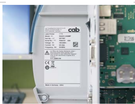
Marquage de plaques signalétiques
