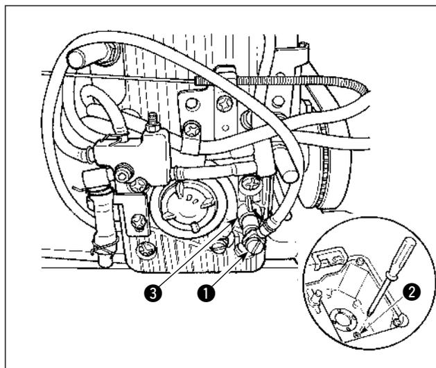
Reposer le bouchon ③ sur l'orifice d'admission de circulation ① comme il se trouvait à la livraison et le fixer solidement sur une position où il ne puisse pas venir en contact avec des pièces en mouvement.
