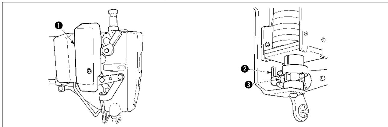
Retirer le couvercle de tire-fil ① et mettre de la graisse sur la partie de la fente ② du socle de solénoïde de tire-fil et sur l'entretoise de bielle de tire-fil ③.
