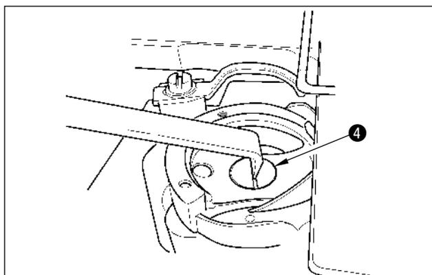
4) Retirer la mèche d'huile ⑤ insérée dans le bouchon d'huile ④ et la remplacer par une neuve.
