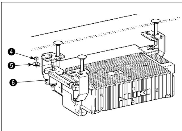
4) Poser la SC-920 sur les tampons en caoutchouc 6 et les fixer avec les écrous 4 et les rondelles 5. Installer la boîte de commande tout en modifiant délicatement la position de la plaque de montage de la boîte de commande qui n'est pas définitivement fixée (celle de droite vue du côté opérateur).
