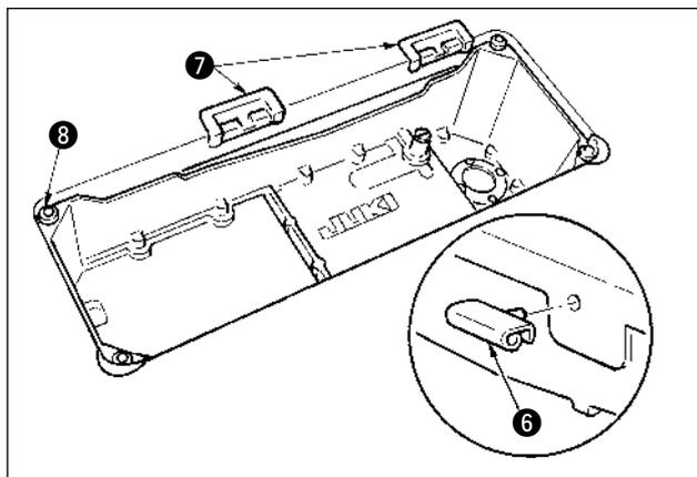
3) Installer les supports des charnières en caoutchouc **7** sur la table et fixer la table avec des clous. Insérer la charnière **6** dans le corps principal de la machine. Engager les charnières sur les supports des charnières en caoutchouc **7** sur la table. Ensuite, abaisser la tête de la machine sur les coussinets de tête de machine **8** situés aux quatre coins de la table.
