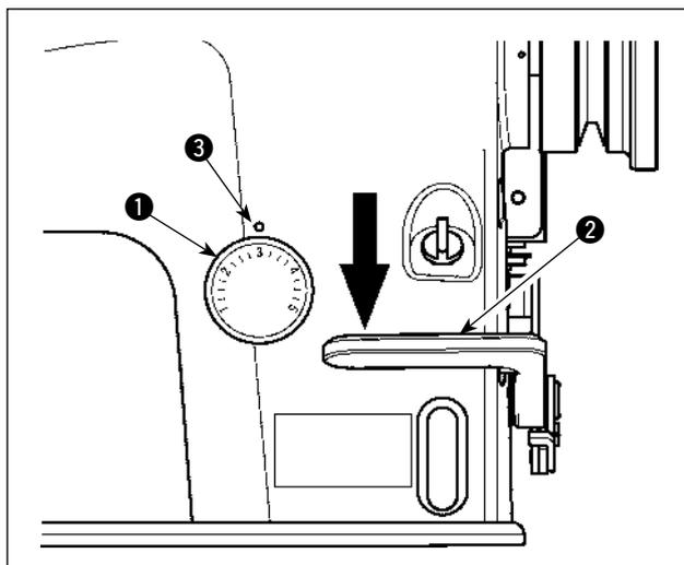
Tourner le cadran de réglage des points ① dans un sens ou dans l'autre pour amener la graduation correspondant à la valeur des points désirée en regard du point de repère ③ du bras de la machine. Si le cadran des points ① est difficile à tourner, le tourner tout en appuyant légèrement sur le levier de commande d'entraînement arrière ②.
