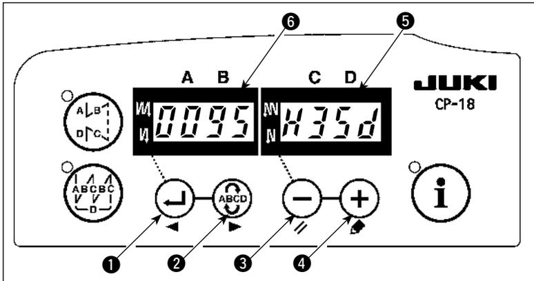
1) Appeler le réglage de fonction No. 95 en se référant à "III-6. Fonctions de réglage de la SC-920" dans le manuel d'instructions pour la SC-920.
