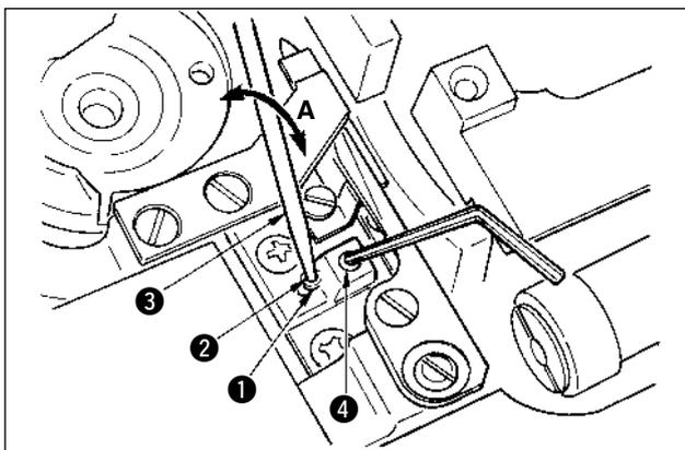
Introduire une tige (tige fine, clé de serrage, etc.) dans l'orifice de réglage (2) du socle de ressort de presseur de fil (1) et desserrer la vis de fixation (4) avec une clé hexagonale de 1,5 mm. Régler le ressort de presseur de fil en déplaçant la tige (3) dans le sens de la flèche A et serrer la vis de fixation (4).
