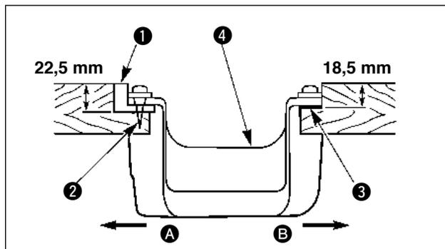
2) Fixer les deux sièges en caoutchouc **1** du côté **A** (côté opérateur) à l'aide de clous **2** comme sur la figure supérieure. Fixer deux sièges-tamppons **3** du côté **B** (côté charnière) avec de la colle caoutchouc. Placer ensuite le couvercle inférieur **4** sur les sièges ainsi fixés.
