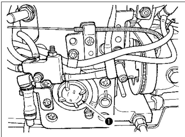
Lors de la vidange du réservoir d'huile, desserrer et retirer le hublot de contrôle de quantité d'huile ❶.
