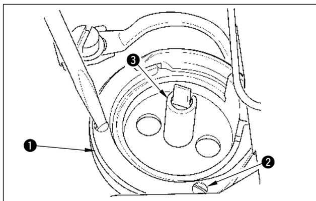
1) Desserrer les vis de fixation ② (petit crochet : 2 points, grand crochet : 3 points) et retirer le lardon de crochet ①.
