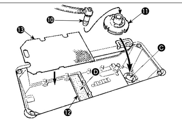
5) Retirer l'orifice d'admission **10** pour la circulation se trouvant sur la plaque de la boîte d'entraînement. L'insérer correctement à fond dans le filtre **11** et placer l'ensemble dans l'ouverture **C**. Placer le filtre en mousse d'uréthane **12** sur **D** et poser le filtre **13** à plaque mince (plaque à tamis fin) par-dessus.
