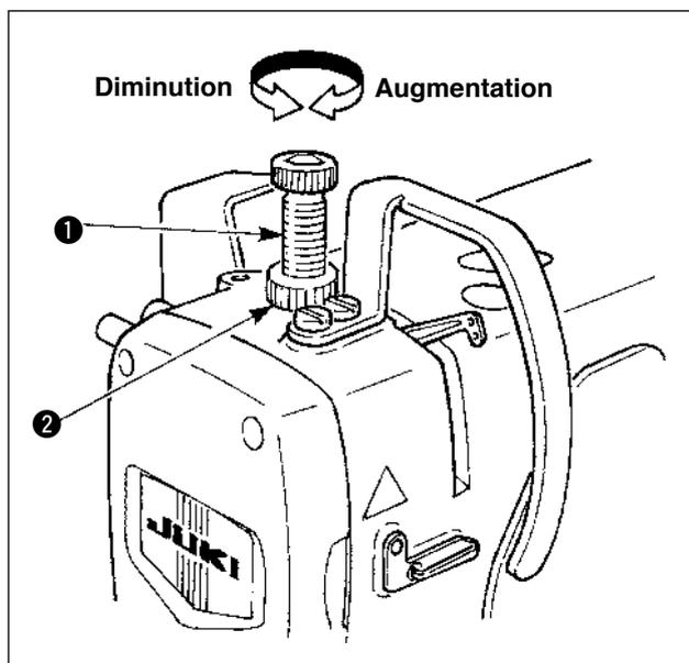
Desserrer l'écrou ② en le tournant dans le sens inverse des aiguilles d'une montre et tourner le régulateur de ressort de presseur ① pour régler la pression.
