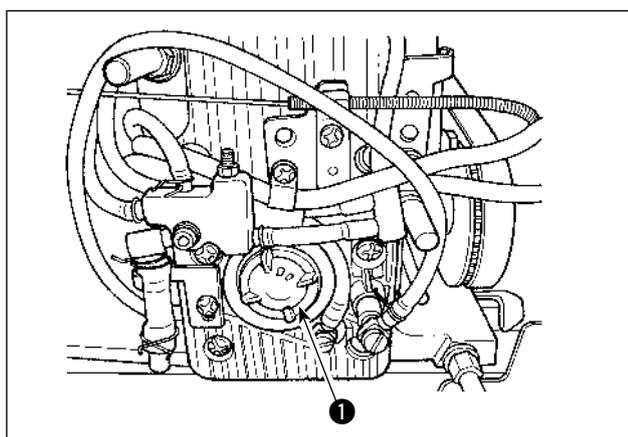
Lorsque la machine à coudre est utilisée, vérifier par le hublot de contrôle de quantité d'huile ① que le réservoir d'huile est suffisamment rempli.
