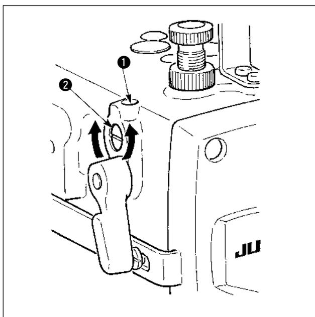
On peut régler la hauteur du pied presseur entre 0 et 0,5 mm en desserrant la vis ① et en tournant l'axe de micro-releveur ②.
