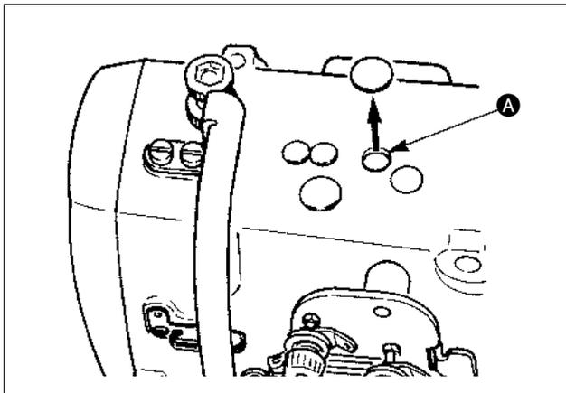
Retirer le bouchon en caoutchouc, sortir le feutre de **A**, verser de la graisse neuve dans l'orifice, puis reposer le feutre que l'on aura imbibé de graisse après avoir enlevé la vieille graisse collée à l'intérieur de l'orifice et sur le feutre.
