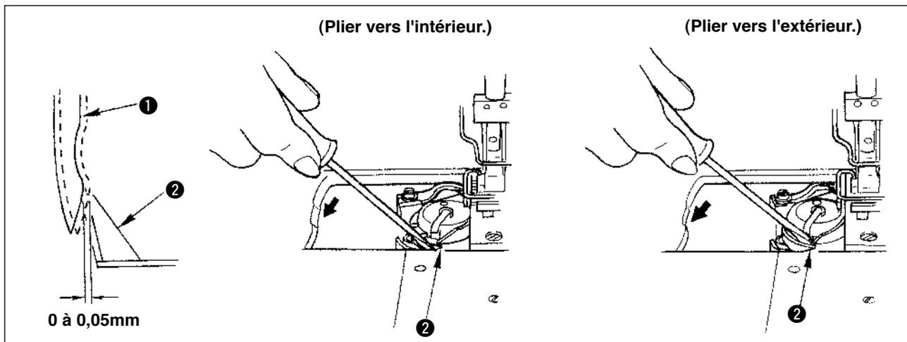
Lors du remplacement du crochet, vérifier la position du garde-aiguille.
