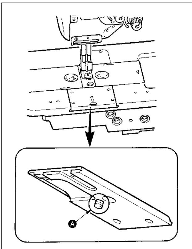
Lorsqu'on visse l'accessoire sur la plaque coulissante, veiller à ce que la vis A ne dépasse pas à l'arrière de la plaque coulissante.
