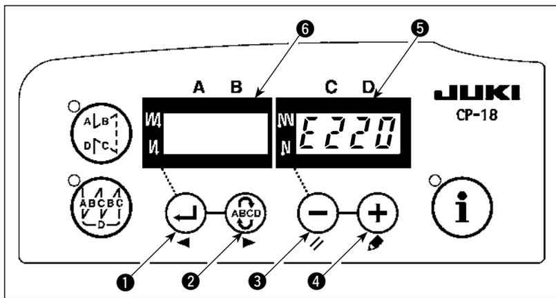
Lorsqu'il est temps de procéder au graissage, le code "E220" apparaît sur l'afficheur ⑤ sur la figure de gauche. Après le graissage, annuler l'avertissement en procédant comme il est indiqué ci-dessous.
