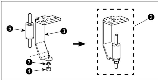
2) Fixer le tampon en caoutchouc 6 sur la plaque de montage de la boîte de commande 3 avec l'écrou 4 et la rondelle à ressort 7. Trois jeux de 2 sont nécessaires.
