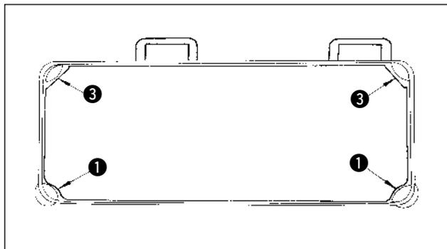
1) Le couvercle inférieur doit reposer sur les quatre coins de la rainure de la table.
