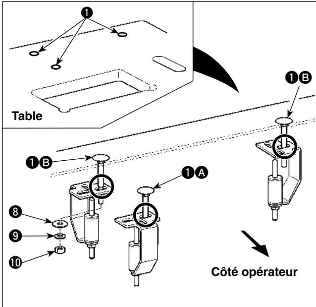
3) Fixer les plaques de montage de la boîte de commande 2 assemblées à l'étape 2) sur la table avec les boulons de décoration 1, les rondelles 8, les rondelles à ressort 9 et les écrous 10. A un endroit vu du côté opérateur visser 1A à fond, mais ne pas visser à fond les deux vis 1B aux deux endroits opposés au côté opérateur.
