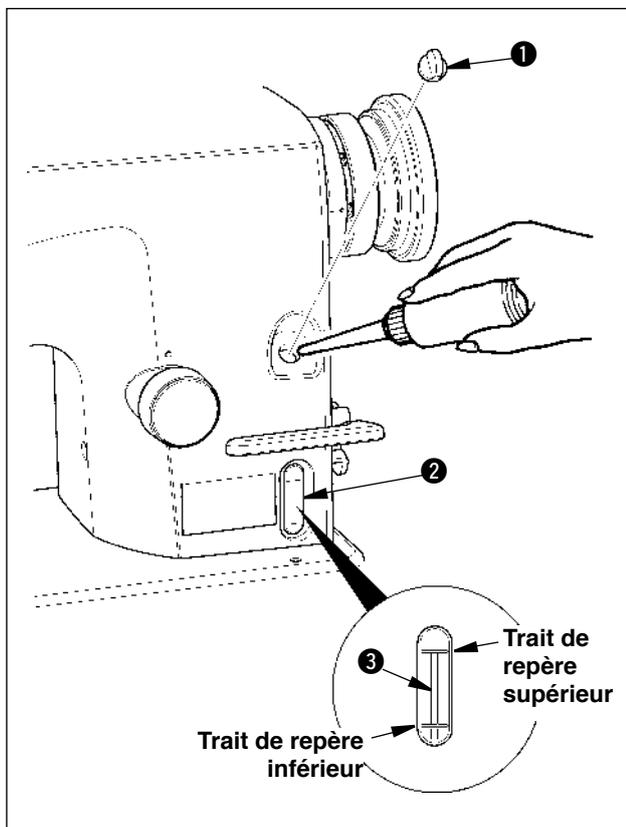
Avant d'utiliser la machine, remplir le réservoir d'huile avec de l'huile pour la lubrification du crochet.
