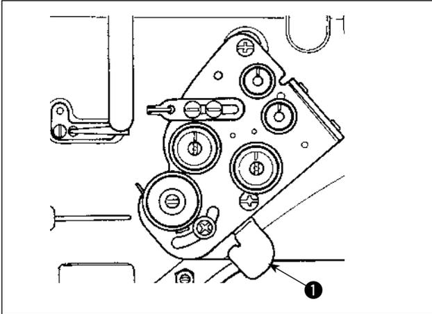
Pour la LH-3568A, 3568A-7, 3588A et 3588A-7, la libération de la tension du contrôleur de tension de fil a été verrouillée avec la genouillère ou le dispositif AK au moment de la livraison.
