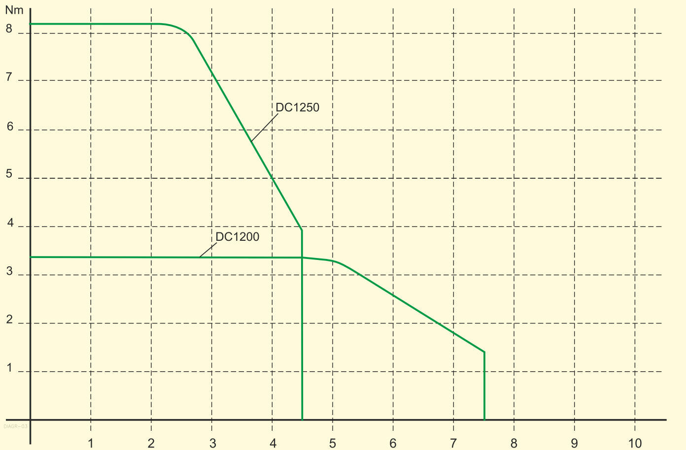
DC1200 / DC1250 Caractéristique de vitesse / couple
