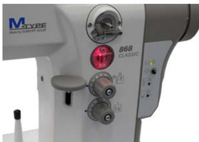
2. Si le niveau d'huile est inférieur au repère minimum (1) : Ajouter de l'huile par l'orifice de remplissage (3) sans dépasser le repère de niveau maximum (2).
