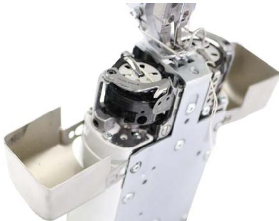
Le crochet de gauche est monté exactement comme le crochet de droite, seulement tourné à 180°.
