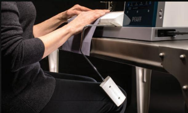
La genouillère ergonomique lève le pied-de-biche en un mouvement facile et confortable, vous permettant ainsi de laisser vos mains sur votre ouvrage.
